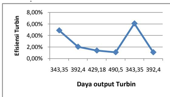
**Gambar 3. Perbandingan Daya dan Efisiensi Turbin menggunakan jumlah nosel**
